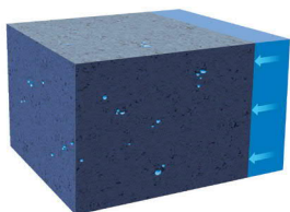
1) 典型的渗水混凝土结构。
